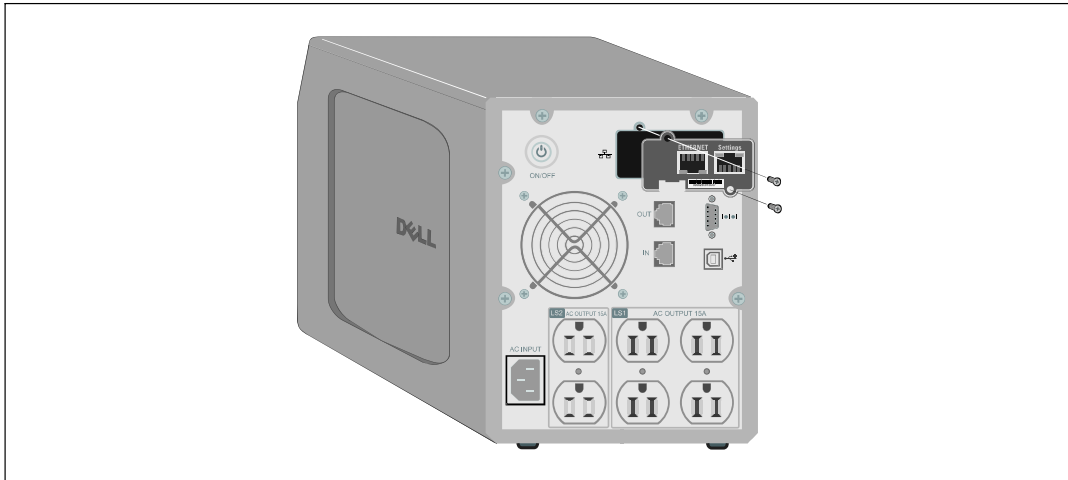
Figure 4. Installation de la carte
